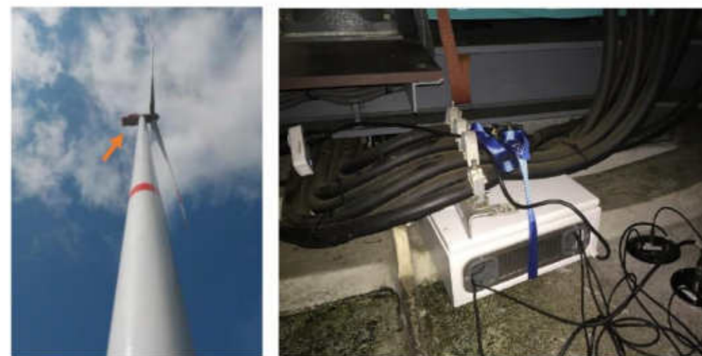
Figure 1 : A gauche, position du microphone au niveau de l'éolienne ; à droite, installation de l'enregistreur dans l'éolienne sur le parc.
